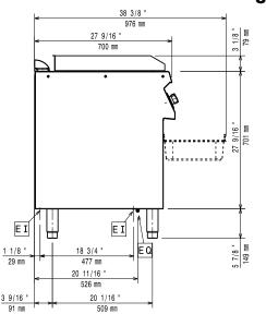
**EI** = Electrical inlet (power) = Equipotential screw
